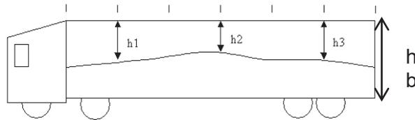
Pour prendre les mesures des trois hauteurs  $h_1, h_2$  et  $h_3$  au minimum, on divise la benne ouverte ou le caisson en six parts égales dans le sens de la longueur et en deux parts égales dans le sens de la largeur.
