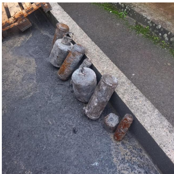
Bouteilles de gaz, d'hélium et de protoxyde d'azote retrouvées dans les mâchefers de l'usine d'incinération. Crédit photo : SYBERT
