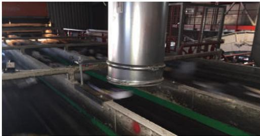
Les travaux ont consisté en l'installation de nouveaux équipements pour la captation et le conditionnement des films plastiques : un tapis équipé de griffes et un réseau d'aspiration pour capter les films, un tri optique supplémentaire pour assurer leur qualité et une presse dédiée pour le conditionnement.
